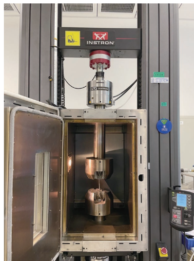
图 4 胶接强度测试示意图
