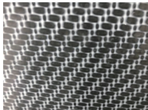
图3 2.5D 编织结构复合材料 Fig.3 2.5D braided structural composites
